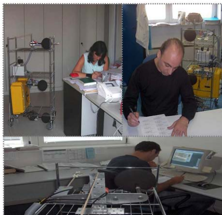
Figura 4.3.1.1-1 Esempio di posizionamento dello strumento di misura mobile in prossimità della postazione di lavoro degli occupanti durante la compilazione del questionario Q1.
