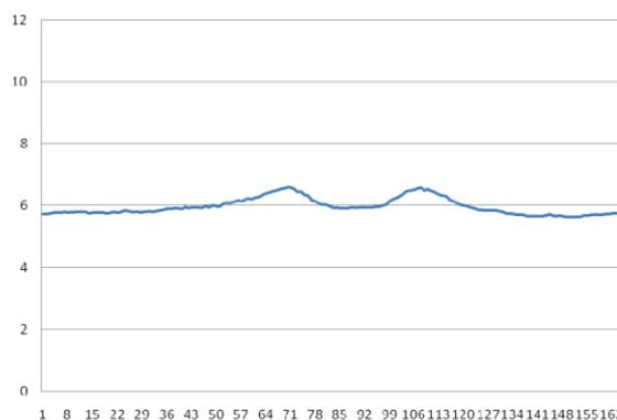
B) Elaborazione agli elementi finiti del ponte termico di facciata in base alle informazioni di progetto o a dati/ipotesi ricavati in loco. L'analisi consente di ricavare un profilo standard delle temperature superficiali da confrontare con quello ricavato dall'indagine termografica.
