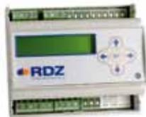
Pannello di controllo per unità di trattamento aria UC 300-M, UC 360-MHE e UC 500-MVHE da barra DIN (6 moduli). Tramite il display è possibile impostare tutti i parametri dell'unità e visualizzare lo stato di funzionamento. È necessario portare al pannello i segnali per la gestione della deumidificazione e dell'integrazione estiva ed invernale. Il rinnovo dell'aria può essere attivato da consenso esterno o tramite programmazione oraria interna.
