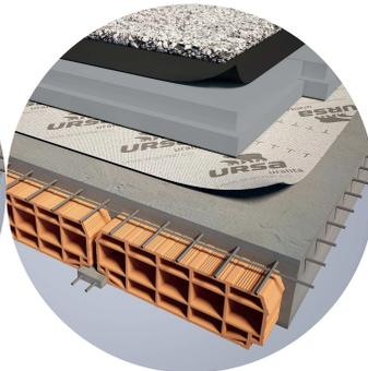
Tetto caldo con membrana bituminosa
