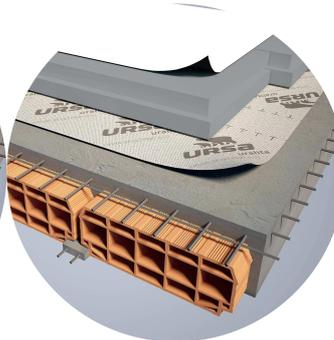
Tetto caldo con membrana sintetica
