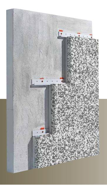
In presenza di supporti problematici, ad esempio con pareti irregolari, differenze di planarità di pannelli prefabbricati o intonaci in condizioni precarie, è consigliabile realizzare il montaggio dei pannelli isolanti mediante guide meccaniche. In questo modo si ottengono sostanziali risparmi per la preparazione dei supporti, anche perché notevoli irregolarità esistenti possono essere facilmente compensate.
