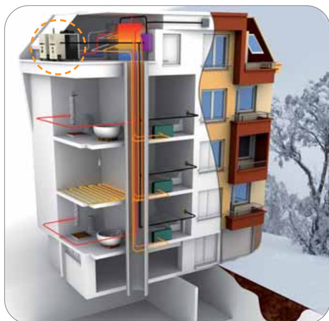
Esempio di applicazione GAHP-AR in funzionamento invernale e estivo con impianto a pannelli radianti, fancoils, produzione indiretta ACS.
