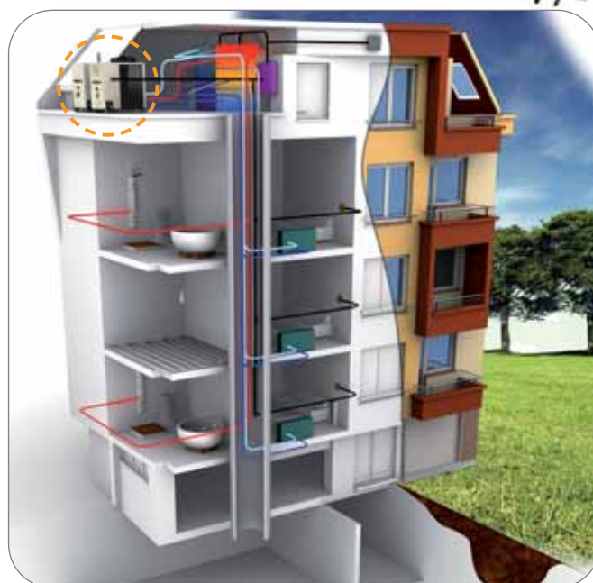
Esempio di applicazione GAHP-AR in funzionamento invernale e estivo con impianto a pannelli radianti, fancoils, produzione indiretta ACS.
