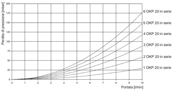
Perdita di pressione senza connessioni e tubi di collegamento
