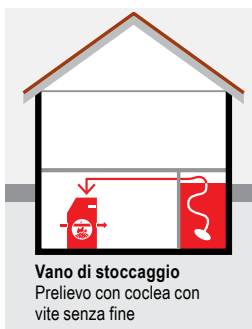
Vano di stoccaggio Prelievo con sonda di aspirazione (standard) o coclea
