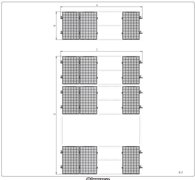
I pacchetti possono essere installati in varie configurazioni, sia con i moduli in verticale che orizzontale, di seguito vengono indicate le dimensioni indicative di ingombro (in mm) possibili con il materiale contenuto nel pacchetto (Fig. 4-1).
