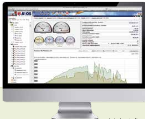
Interfaccia Energy Control per il monitoraggio dei consumi
