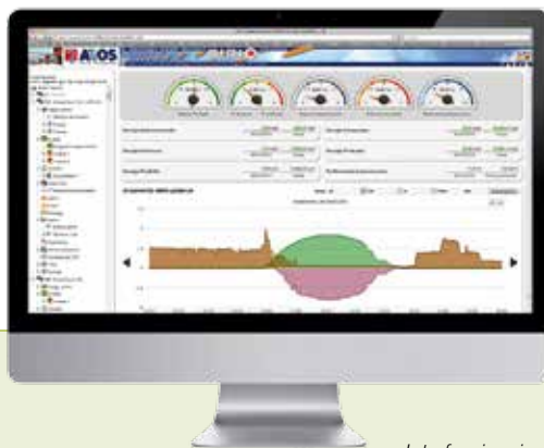
Interfaccia principale di monitoraggio per impianti fotovoltaici
