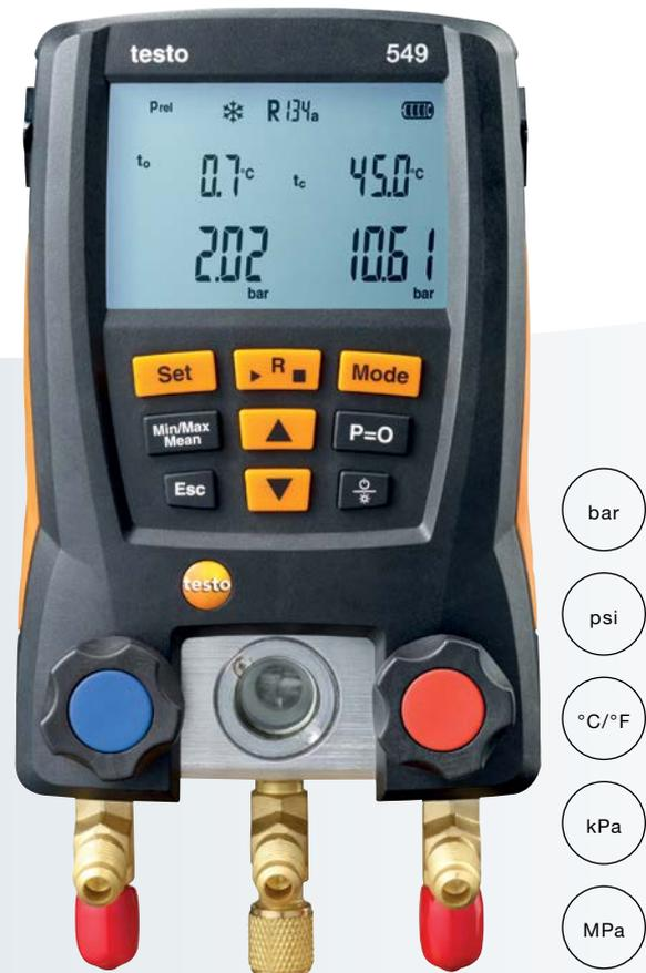
Il nuovo testo 549, è uno strumento robusto per il lavoro quotidiano su impianti di refrigerazione e pompe di calore. Il blocco valvole a 2 vie con 3 connessioni e 3 attacchi per flessibili permette un lavoro più rapido e semplice. La custodia robusta e il telaio metallico attorno al display proteggono il nuovo testo 549 da eventuali urti in modo ancora più affidabile. Il gancio a sospensione garantisce
