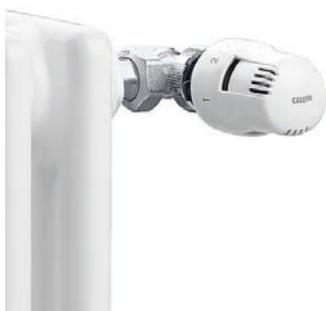
E' l'elemento che esegue la termoregolazione e si installa sul termosifone. Mantiene costante la temperatura del locale regolando (aumentando o diminuendo) la quantità di acqua calda che passa nel radiatore in funzione della temperatura ambiente impostata con la manopola di regolazione.
