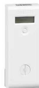
E' l'apparecchio che viene installato direttamente a contatto del corpo scaldante e ne quantifica la quantità di calore emessa. E' di ridotte dimensioni (all'incirca grande come un telefonino) e viene fissato in modo irrimovibile sul termosifone in modo che non possa essere manomesso.
