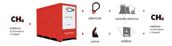
Il TOTEM 20 utilizza 6,3 m³ di Metano per la produzione di 20 kW di elettricità e 42 kW di calore contro i 9,3 m³ necessari a una caldaia e a una centrale elettrica per il medesimo fine.
