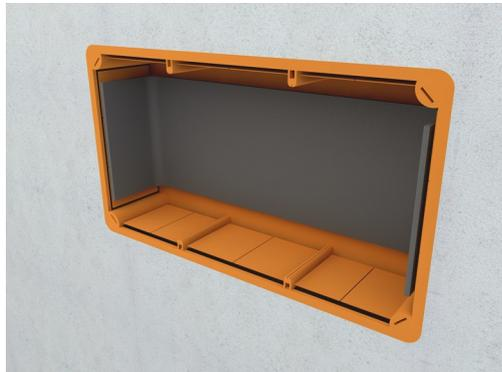
**AF E-BOX** è una guaina intumescente progettata specificamente per la protezione antincendio delle scatole elettriche inserite in pareti resistenti al fuoco. È costituita da un elemento intumescente termo-espandente avente la specifica funzione di mantenere il grado di resistenza al fuoco della parete nel caso in cui vengano introdotte delle soluzioni di continuità come appunto le scatole portafrutti negli impianti elettrici.
