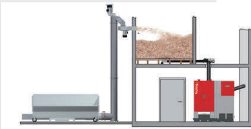
Il deposito si trova sopra il livello del locale caldaia. Il caricamento di combustibile alla caldaia viene realizzato mediante un tubo di caduta. Qui si consiglia di utilizzare una valvola a stella. Il deposito può essere riempito comodamente con l'estrattore a coclea verticale o tramite immisione del combustibile.
