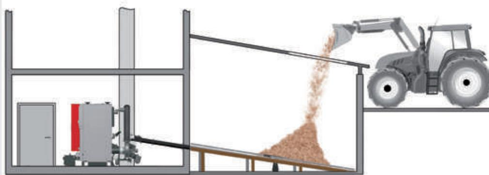
Il deposito si trova all'esterno, sotto il livello di accesso veicolare. Il combustibile viene ribaltato nel deposito dall'alto. Il deposito di combustibile può essere realizzato perlopiù tramite un ampliamento economico.
