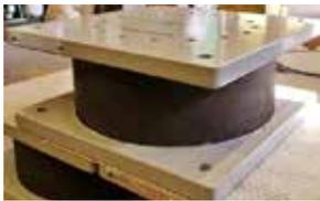
Gli isolatori elastomerici sono dispositivi di appoggio in gomma-acciaio posti alla base della struttura a progetto (ponti o strutture civili), progettati per avere opportuni valori calibrati di rigidità orizzontale e smorzamento equivalente, al fine di realizzare l'opportuno sistema di isolamento per la struttura stessa.
