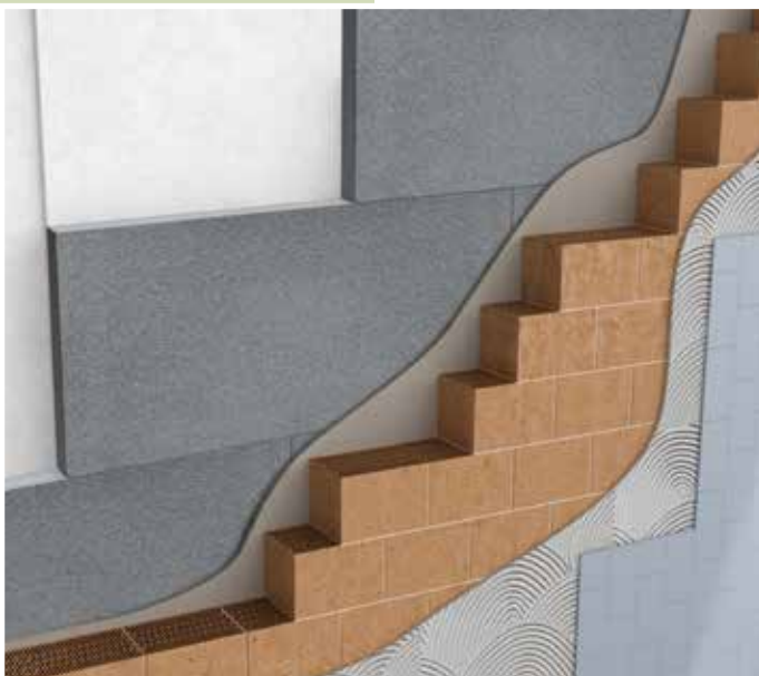
Isolamento in controplaccaggio su parete in laterizio
