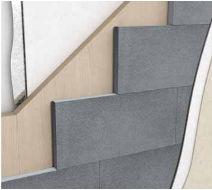
Isolamento a cappotto su parete in legno
