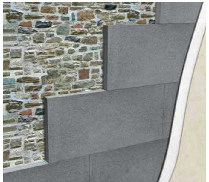
Isolamento a cappotto su parete in pietra
