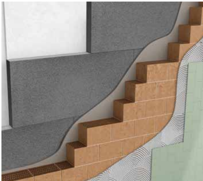
Isolamento in controplaccaggio su parete in laterizio
