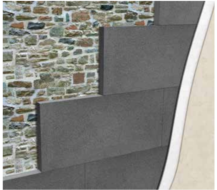
Isolamento a cappotto su parete in pietra
