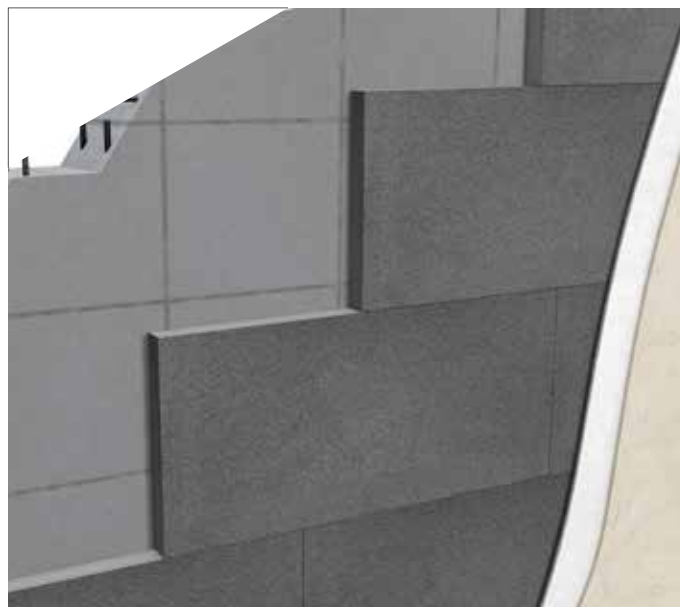
Isolamento a cappotto su parete in calcestruzzo
