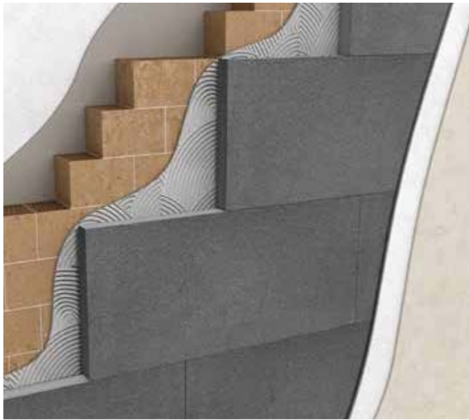
Isolamento a cappotto su parete in laterizio
