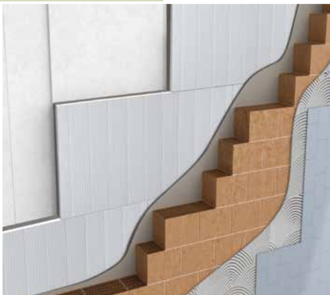
Isolamento in controplaccaggio su parete in laterizio
