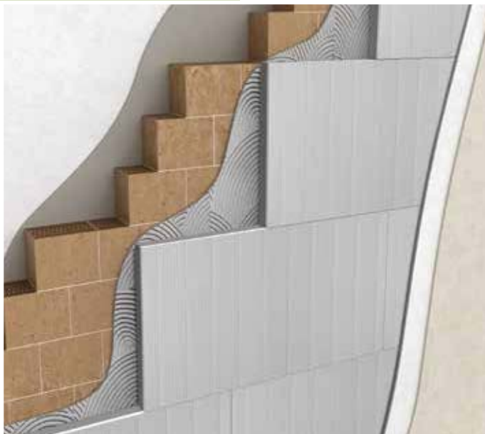
Isolamento a cappotto su parete in laterizio
