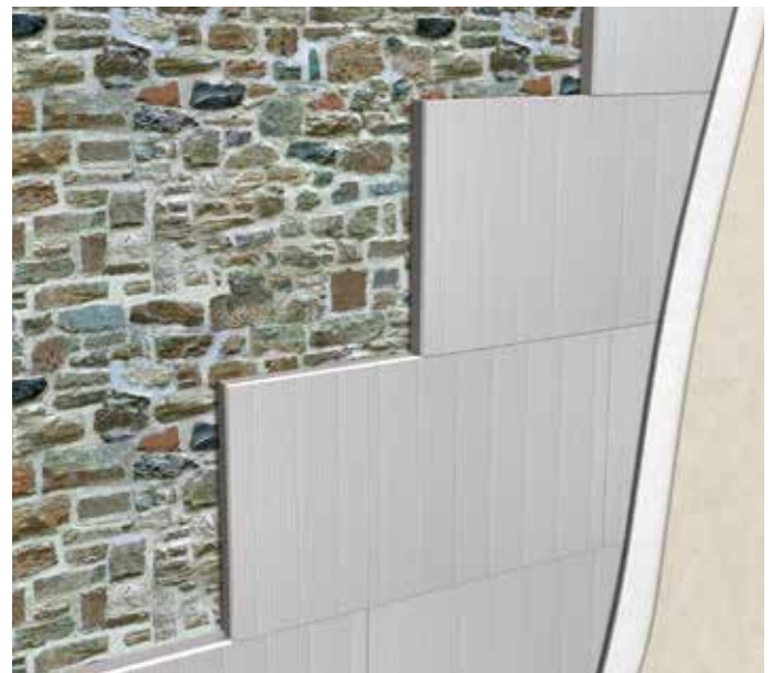
Isolamento a cappotto su parete in pietra
