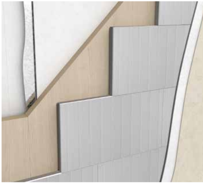
Isolamento a cappotto su parete in legno
