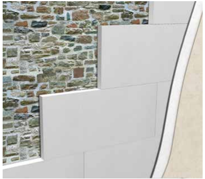
Isolamento a cappotto su parete in pietra
