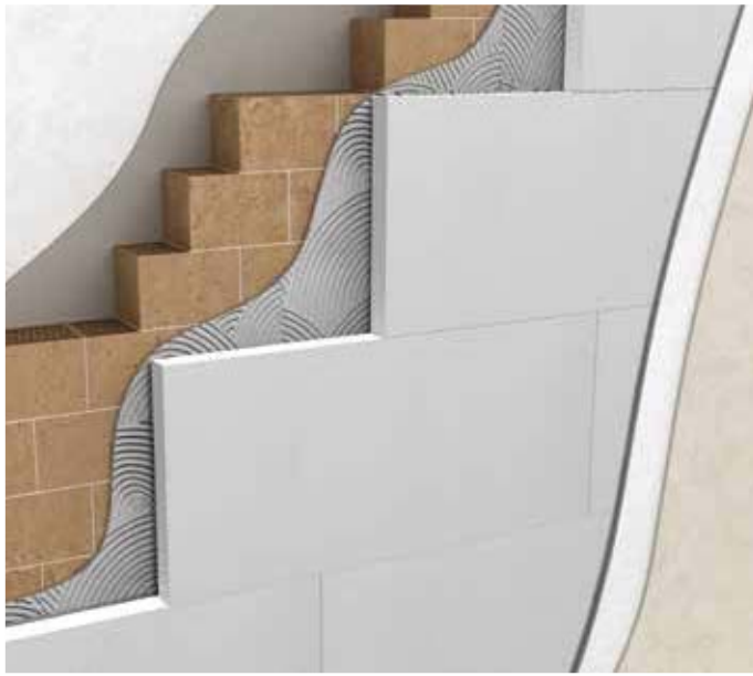
Isolamento a cappotto su parete in laterizio
