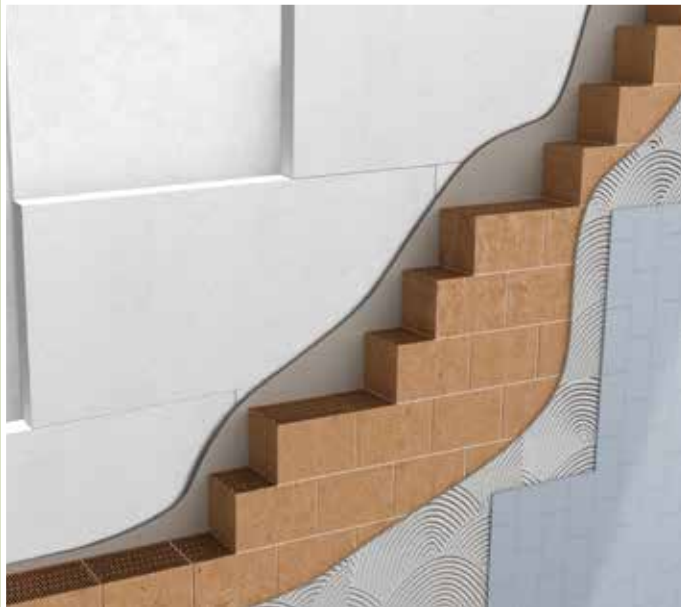
Isolamento in controplaccaggio su parete in laterizio
