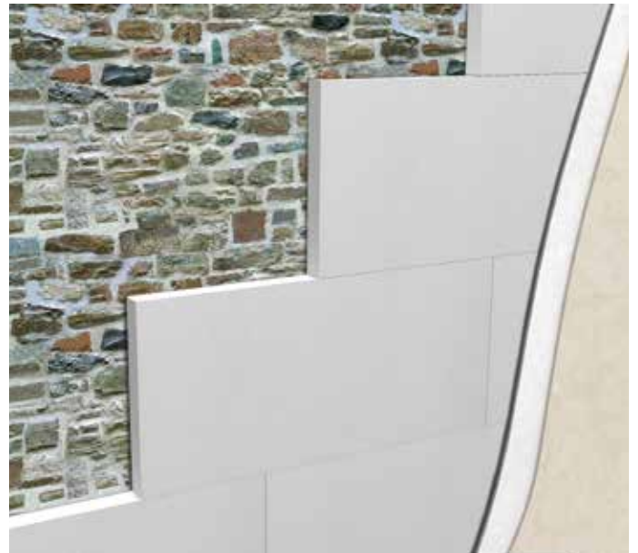
Isolamento a cappotto su parete in pietra
