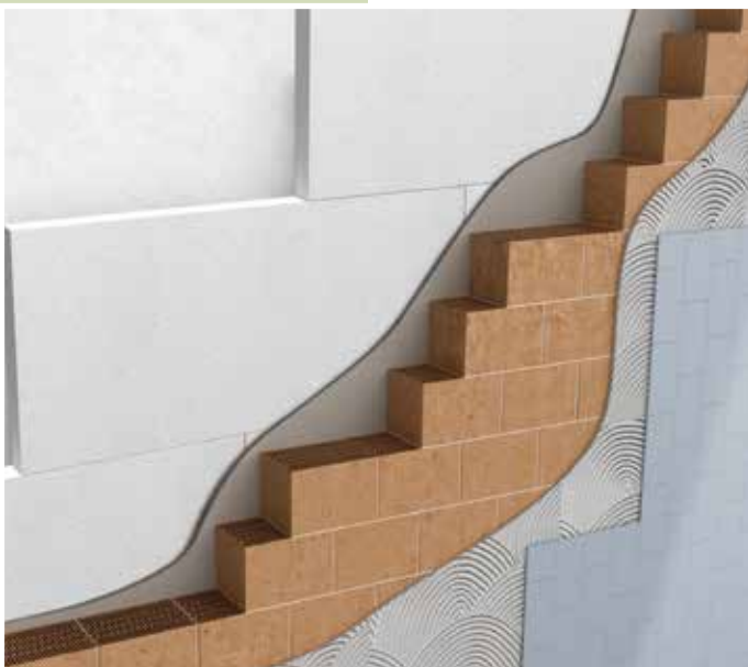
Isolamento in controplaccaggio su parete in laterizio
