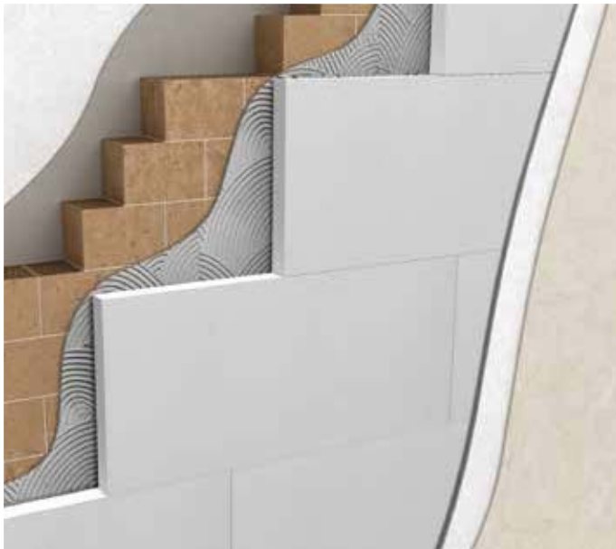
Isolamento a cappotto su parete in laterizio
