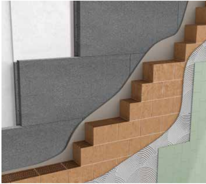
Isolamento in controplaccaggio su parete in laterizio
