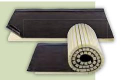
Dimensioni rotolo: 8000/6000/5000x1000 mm Dimensioni pannello: 2400/1200x1000 mm Sistema termoisolante in schiuma poli isocianurato espanso con finitura in cartonfeltro bitumato, disponibile in formato rotolo (costituito da doghe) o lastra, accoppiato a membrana bitume polimero plastomerica (APP) o elastomerica (SBS), armata in velo vetro (VV) o in tessuto non tessuto di poliestere (PE) di diverso spessore o peso e con finitura liscia o ardesiata (GR).
