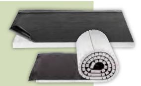
Dimensioni rotolo: 8000/6000/5000x1000 mm Dimensioni pannello: 2000/1000x1000 mm Sistema termoisolante impermeabile in polistirene espanso sinterizzato a vapore in formato rotolo (costituito da doghe) o lastra, accoppiato a membrana bitume polimero plastomerica (APP) o elastomerica (SBS), armata in velo vetro (VV) o in tessuto non tessuto di poliestere (PE) di diverso spessore o peso e con finitura liscia o ardesiata (GR).
