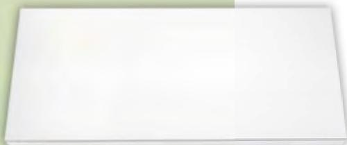
Pannello in polistirene espanso sinterizzato, tagliato da blocco, a bordo dritto, accoppiato, sul lato esterno, a lastra in cartongesso da 10 o 12,5 mm di spessore.
