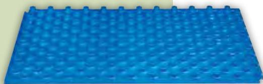
Pannello termoisolante in polistirene espanso sinterizzato, stampato con bugne di 25 mm di spessore a passo 50 mm, idoneo per tubazioni da 15-17 mm di diametro, con bordi perimetrali ad incastro e rivestito da film termoplastico blu, avente funzione di barriera al vapore.
