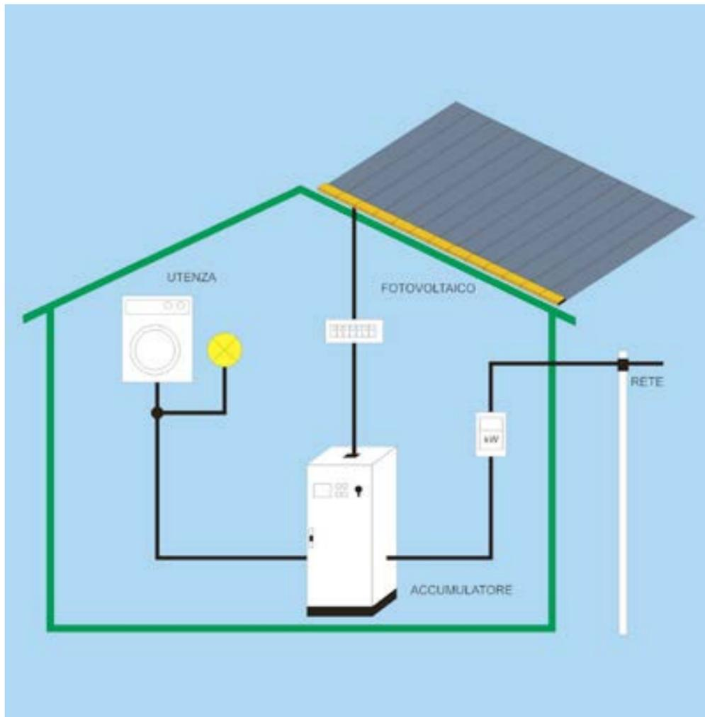
Il sistema a batterie funge anche da gruppo di continuità (UPS) permettendo un'erogazione costante di energia anche in caso di black-out, garantendo quindi il funzionamento dei dispositivi fondamentali (frigoriferi, congelatori, caldaia, pompe anti-allagamento, dispositivi medici...) e dell'impianto di illuminazione.
