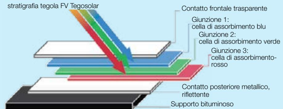
In questo modo le celle FV convertono in elettricità uno spettro più ampio di luce rispetto ai moduli tradizionali perché **producono energia con luce diretta** ma anche in condizioni di **luce diffusa**, ossia quando il sole è basso, quando il cielo è nuvoloso e quando le celle sono installate con orientamento ed inclinazione non favorevoli.
