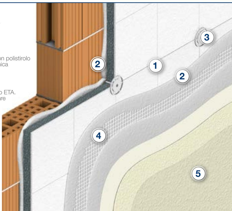
**Hightherm 030** presenta un ottimo valore di conducibilità termica, che rappresenta il TOP tra i pannelli isolanti del Sistema Fassatherm®
