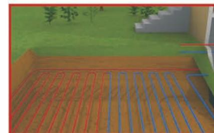
Sonda geotermica orizzontale
