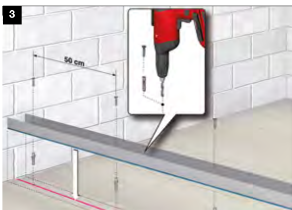
3. POSIZIONAMENTO E FISSAGGIO GUIDA A PAVIMENTO Il fissaggio avviene mediante tasselli previa foratura del supporto, o direttamente con pistola sparachiodi.
