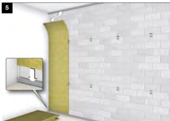
5. INSERIMENTO MATERIALE ISOLANTE NELL'INTERCAPEDINE
