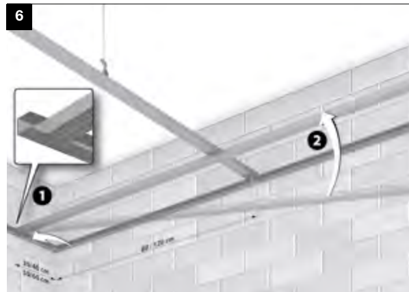
6. INSERIMENTO PROFILI PRIMARI NELLE GUIDE E ESUCCESSIVO AGGANCIAMENTO AI PENDINI
