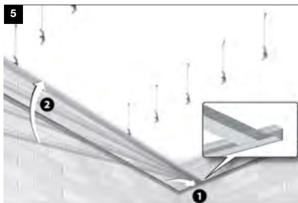
5. INSERIMENTO PROFILI NELLE GUIDE
