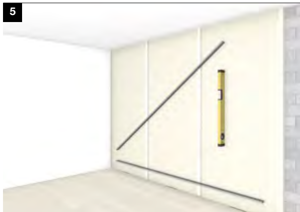
5. ALLINEAMENTO DELLE LASTRE
