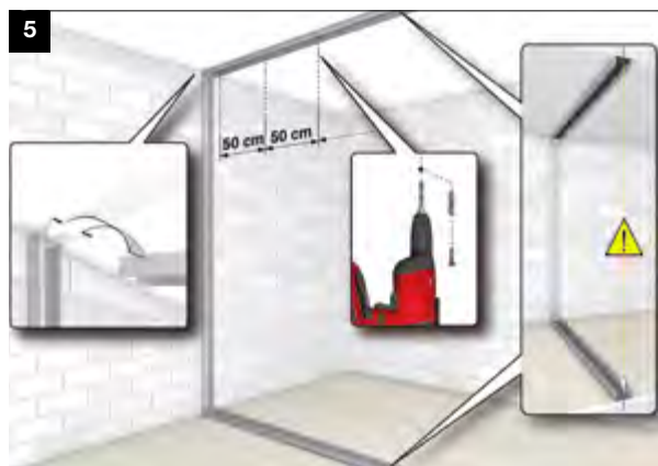
5. POSIZIONAMENTO E FISSAGGIO GUIDA A SOFFITTO
