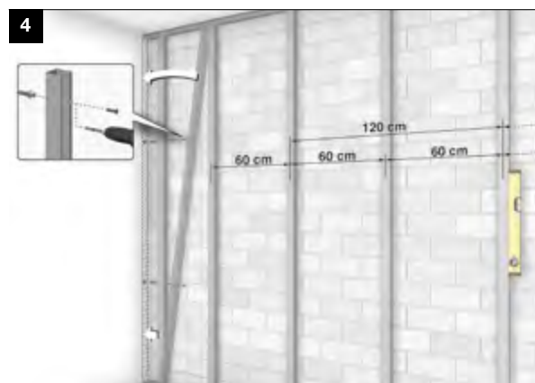
4. INSERIMENTO E FISSAGGIO DEI MONTANTI
