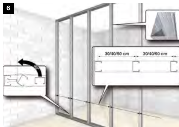
6. INSERIMENTO E POSIZIONAMENTO DEI MONTANTI
