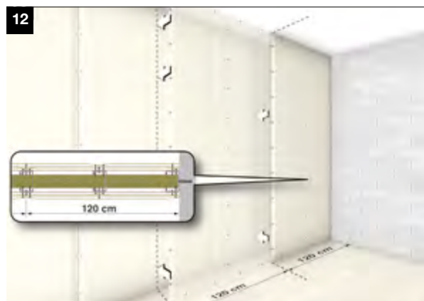
12. POSIZIONAMENTO E AVVITATURA DEL SECONDO STRATO DI LASTRE
