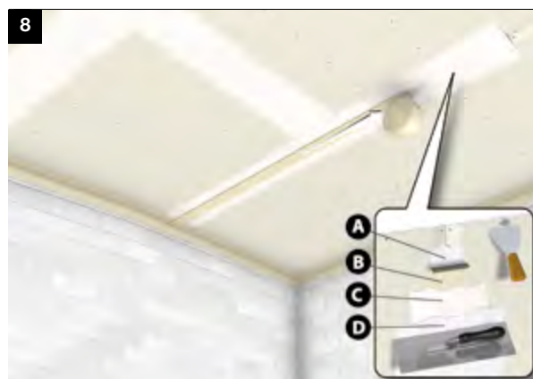
8. TRATTAMENTO DEI GIUNTI E DELLE TESTE DELLE VITI A. Stucco B. Nastro di rinforzo C. Stucco D. Finitura
