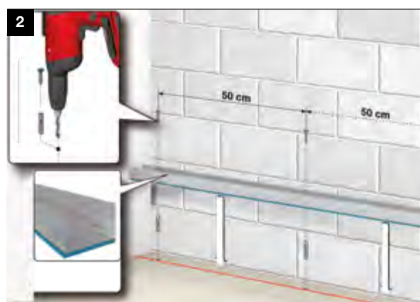
2. POSIZIONAMENTO E FISSAGGIO GUIDA A PAVIMENTO
