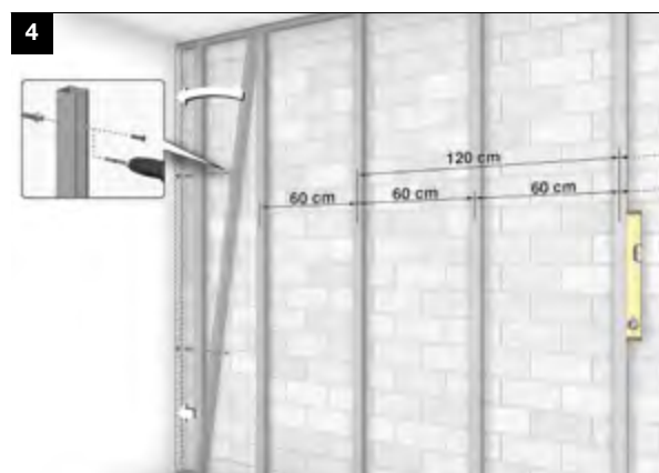
4. POSIZIONAMENTO E FISSAGGIO DEI PUNTI DI ANCORAGGIO MECCANICO ALLA PARETE
