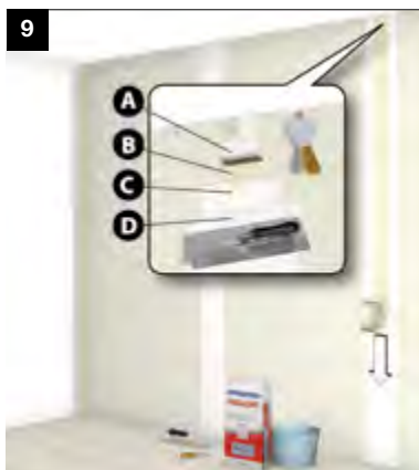
9. TRATTAMENTO DEI GIUNTI E DELLE TESTE DELLE VITI A. Stucco B. Nastro di rinforzo C. Stucco D. Finitura
