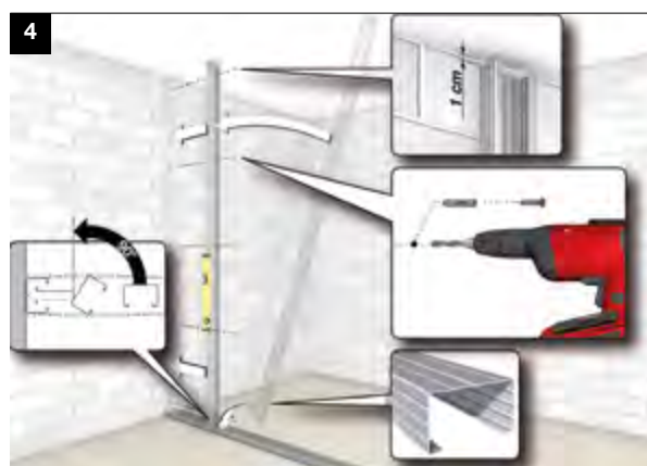
4. INSERIMENTO E FISSAGGIO DEI MONTANTI DI PARTENZA E DI ARRIVO
