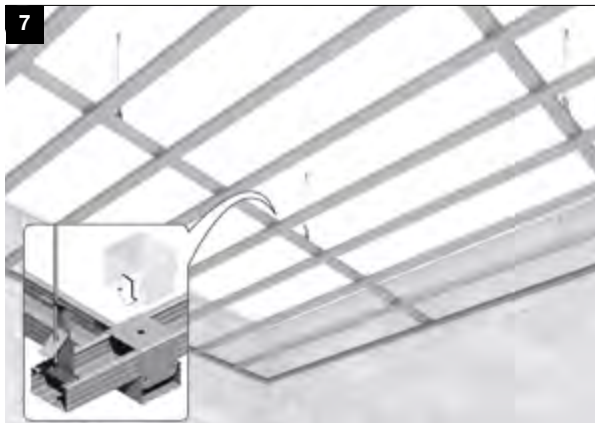
7. AGGANCIAMENTO DELL'ORDITURA SECONDARIA ALLA PRIMARIA
