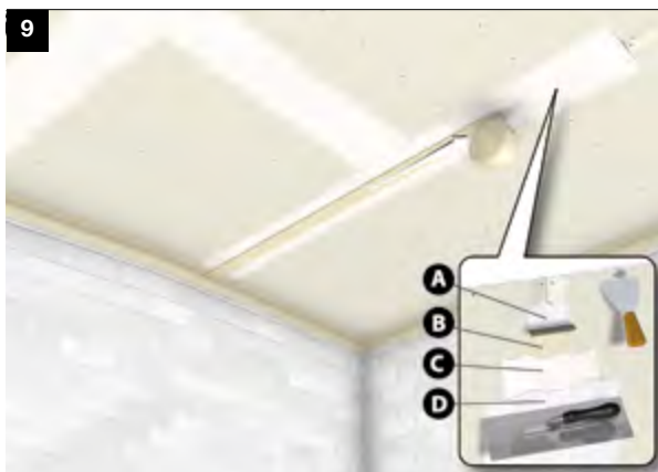
8. TRATTAMENTO DEI GIUNTI E DELLE TESTE DELLE VITI
