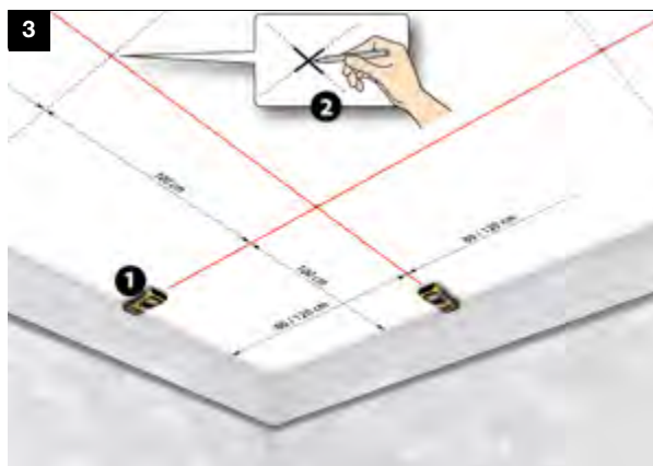
3. TRACCIAMENTO INTERASSE PROFILI E PENDINI
