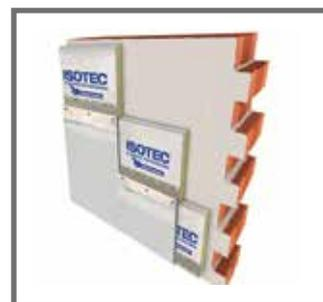
Realizzazione di isolamento esterno di edificio adibito ad asilo nido mediante pannelli Isotec Linea di spessore 10 cm e rivestimento finale in lastre fibrocemento porta-intonaco.
