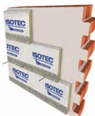
Il pannello Isotec Linea viene fissato alla struttura portante tramite tasselli ad espansione e viti d'ancoraggio passanti attraverso il correntino. Tipo e numero di fissaggi dipenderanno dalla struttura e dal peso del rivestimento. Avvalersi, per tale operazione, dei fori presenti nel correntino metallico, avendo cura di alternarne la posizione.
