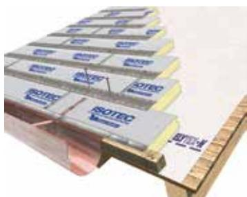
Consolidare alla struttura il pannello Isotec Linea, utilizzando fissaggi meccanici partendo dal canale di gronda e proseguendo verso il colmo. Avvalersi, per tale operazione, dei fori presenti nel correntino metallico.
