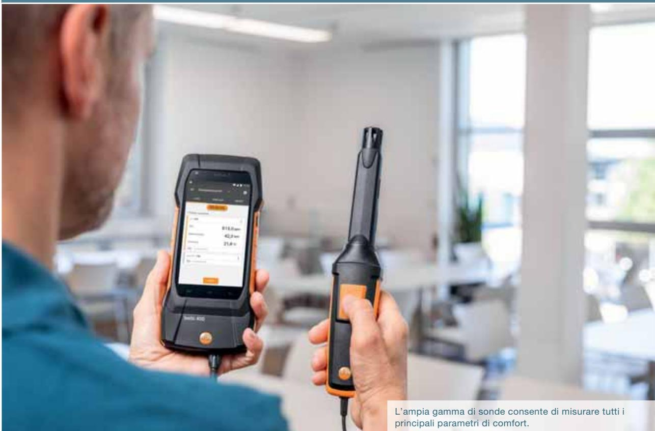
L'ampia gamma di sonde consente di misurare tutti i principali parametri di comfort.
