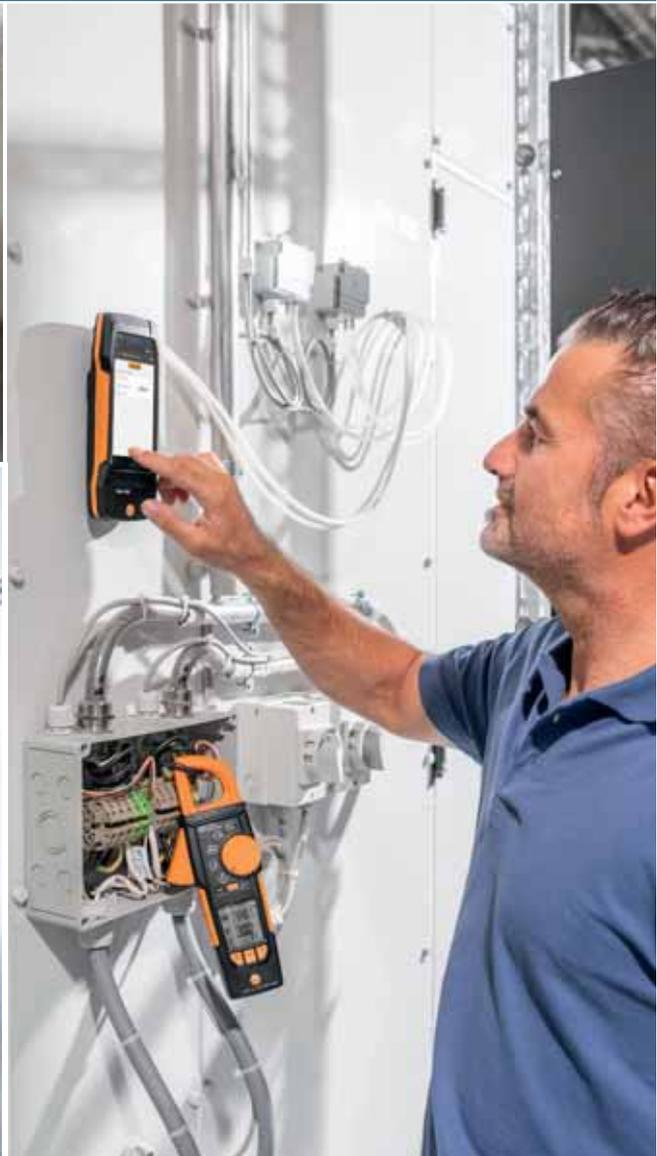
Con lo strumento testo 400 è possibile utilizzare fino a otto sonde (4 con Bluetooth, 4 con cavo) contemporaneamente.
