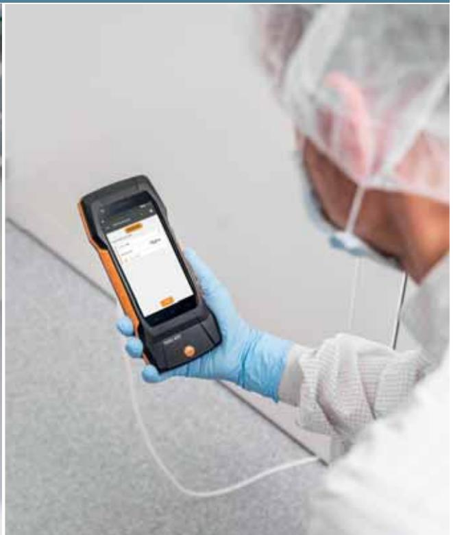
Il sensore di pressione differenziale dello strumento testo 400 risponde ai requisiti di precisione contenuti nella norma ISO 14644.
