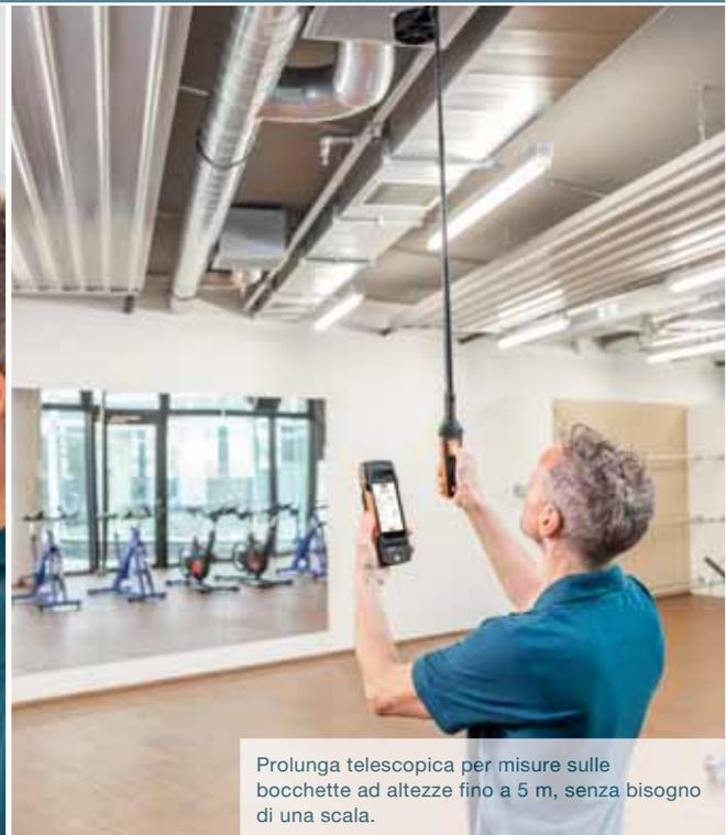
Prolunga telescopica per misure sulle bocchette ad altezze fino a 5 m, senza bisogno di una scala.
