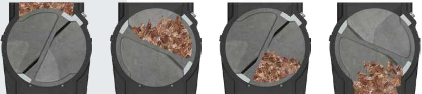
Le due ampie camere (diametro del rotore 200 mm) si prestano ottimamente ad alloggiare cippato fino a P31S (ex G50). Una resistenza elevata viene riconosciuta automaticamente. La valvola a stella e la coclea si muovono all'indietro (più volte a seconda dei parametri impostati) fino a quando è possibile il trasporto successivo.
