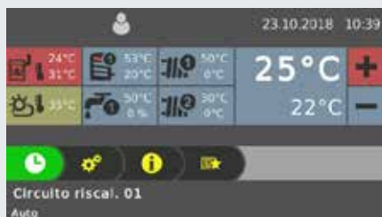
Fig. 1 Vista d'insieme generale del circuito di riscaldamento (videata iniziale)
