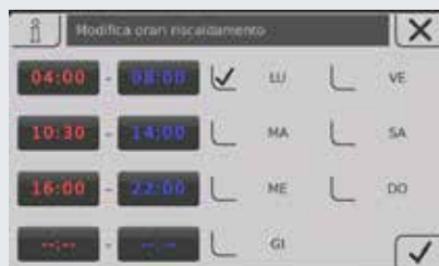
Fig. 2 Videata dei tempi di riscaldamento (impostabili singolarmente)
