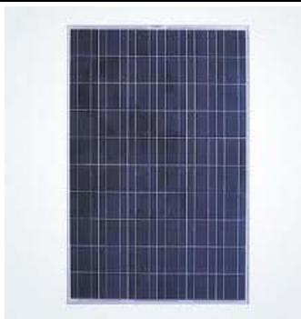
Moduli composti da 60 celle in silicio multicristallino ad alta efficienza, da 156x156mm. L'uso del vetro temperato dell'EVA e del TEDLAR di alta qualità, nel processo di incapsulamento, garantisce alle celle fotovoltaiche la massima protezione ed un alto grado di rendimento anche in condizioni atmosferiche avverse. La presenza di diodi di bypass offre sicurezza contro eventuali danni da ombreggiamento.
