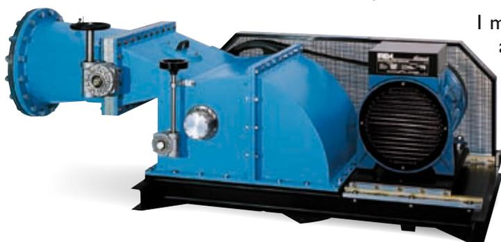
I modelli TBA sono dotati di generatore asincrono trifase 4-6 poli, 400/230 Volt 50/60Hz. Valvola generale automatica ad azionamento elettrico in c.c., regolazione manuale o automatica della portata da 0 a 100%.
