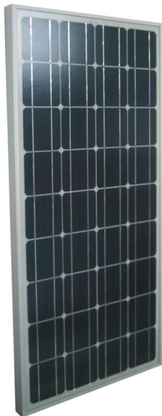
I moduli fotovoltaici **IS50P e IS60P** sono costituiti da 36 celle in silicio monocristallino ad alta efficienza 103x103 mm prodotte con trattamento antiriflesso.
