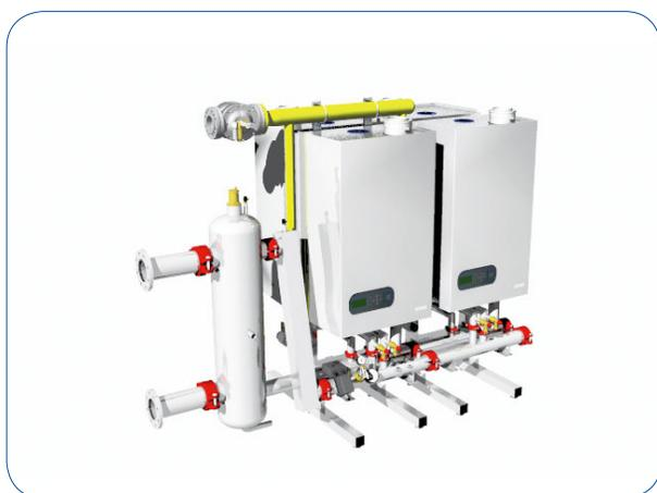
EQUILIBRATORE IDRAULICO VERTICALE A STRATIFICAZIONE A bassa velocità per favorire la stratificazione termica e la separazione dell'aria e dei fanghi, corpo in acciaio verniciato PN6, attacchi laterali contrapposti per generatore termico e impianto, attacco centrale per vaso d'espansione e per riempimento, attacco superiore per disaeratore, attacco inferiore di scarico, piedini regolabili.
