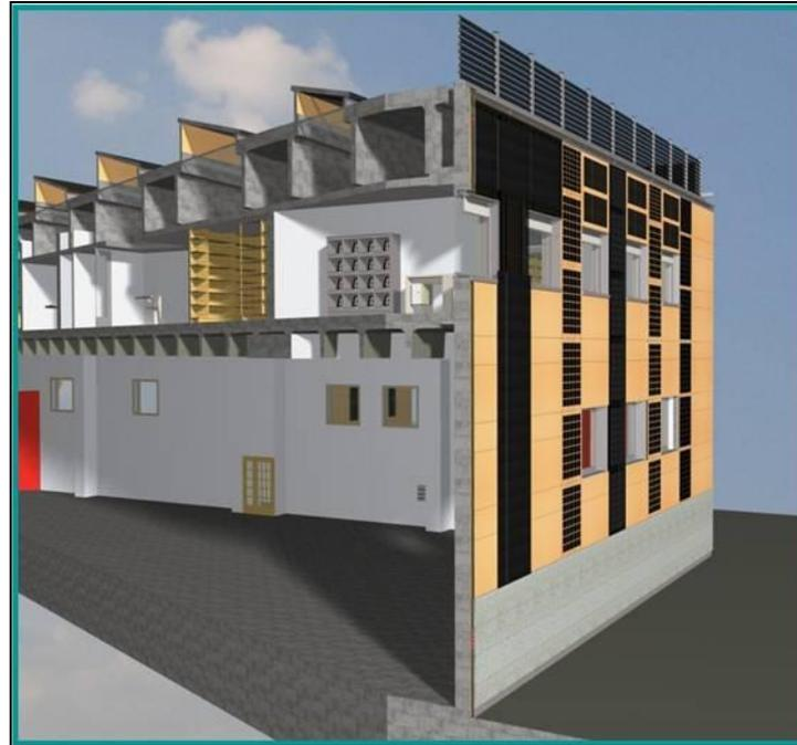
Malgrado l'inerzia termica di questi elementi del sistema sia minima, quindi non consentano accumulo termico, compiono una limitata azione di resistenza al raffreddamento notturno, interponendo comunque uno strato d'aria immobile tra paramento esterno e isolante, con vantaggio rispetto ad un contatto materiale che favorirebbe la trasmissione di calore verso l'esterno.
