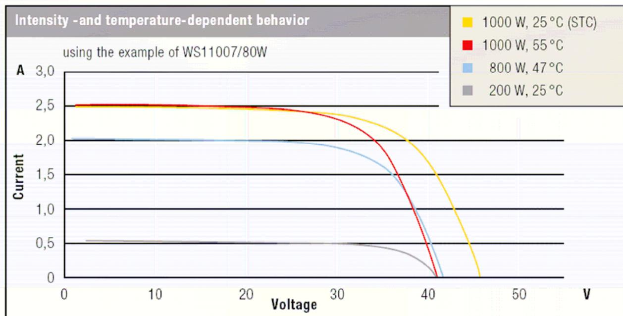
La curva gialla rappresenta lo standard di laboratorio, quella grigia la potenza irradiata che nella realtà provoca una temperatura sul semiconduttore di 25°C.
