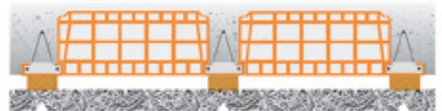
Solaio in laterocemento rivestito con pannelli Celenit fissati ad una listellatura in legno.
