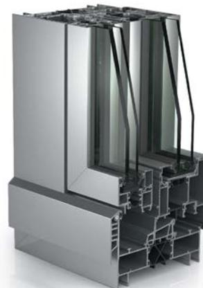
WICLINE 125 è un sistema di finestre composto con prestazioni di isolamento termico ed acustico particolari. L'anta interna è combinata con un'anta aggiuntiva esterna. Questa composizione incrementa significativamente le funzionalità di protezione della finestra, come l'isolamento termico ed il comfort abitativo. È possibile integrare sistemi di protezione solare in ambiente protetto fra l'anta interna e quella esterna.
