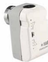
La corretta regolazione di ogni attuatore è assicurata dalle misure della temperatura ambiente, effettuata dal cronotermostato, e della temperatura prossima al radiatore, rilevata dall'attuatore stesso. L'**algoritmo** di EQUICALOR®, sottoposto a brevetto, permette la correzione della temperatura di prossimità e la riconduce alla temperatura ambiente, dato necessario per la regolazione, **senza bisogno di ulteriori termostati ambiente**.
