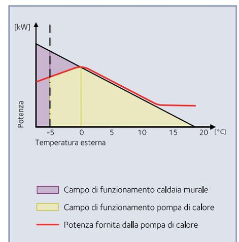
Per massimizzare l'efficienza energetica Talia Green Hybrid utilizza principalmente una pompa di calore aria-acqua modulante che adatta la potenza erogata esattamente alla richiesta istantanea dell'impianto. I benefici di una potenza modulante risultano ancora più evidenti in termini di efficienza stagionale di sistema. La taglia della pompa sarà quella ideale per soddisfare nel modo più efficiente la gran parte del fabbisogno termico.
