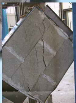
Il campione, è stato sottoposto in diagonale a taglio sismico, con carico di 889 kg, fino alla rottura. Come si nota il muro si è appena lesionato senza cedere al peso. Ciò dimostra che il sistema antisismico AFON CASA è in grado di resistere a fortissime spinte telluriche.
