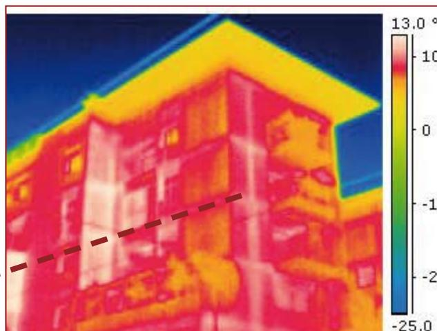
La struttura portante in cemento armato crea un ponte termico e diventa mezzo di trasmissione preferenziale del calore verso l'esterno
