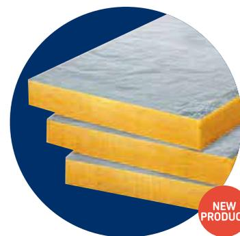
Pannello idrorepellente in lana di vetro URSA GLASSWOOL trattata con speciali resine termoindurenti rivestito su di una superficie con carta kraft alluminio retinata con funzione di barriera al vapore, e sull'altra con velo vetro.
