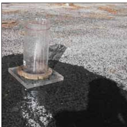
Prova di capacità drenante.
