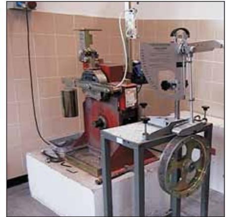
Apparecchiatura per la verifica del C.L.A.
