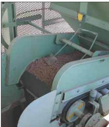
Il conglomerato bituminoso con argilla espansa è costituito da una miscela con aggregati naturali combinati percentualmente e legati con bitume a caldo in normali impianti di produzione. In funzione della percentuale di argilla espansa impiegata e dell'assortimento granulometrico, queste miscele presentano anche elevate caratteristiche di fonoassorbenza.
