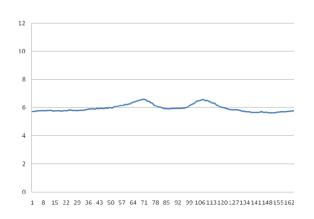
B) Elaborazione agli elementi finiti del ponte termico di facciata in base alle informazioni di progetto o a dati/ipotesi ricavati in loco. L'analisi consente di ricavare un profilo standard delle temperature superficiali da confrontare con quello ricavato dall'indagine termografica.
