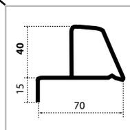
Correntino in acciaio rivestito in lega di alluminio, zinco e silicio, **h. 4 cm**
